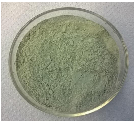
Figura 2. Producto final del proceso de inmovilización de papaína en zeolita
