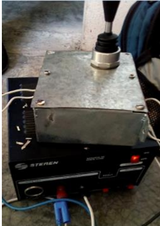
Figura 10. Prototipo del control remoto para manipular el cañón de agua
